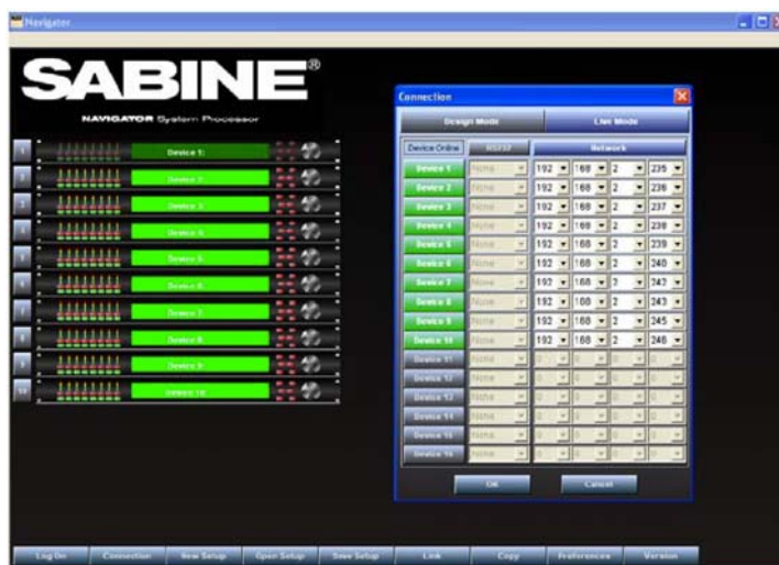
Hlavní obrazovka ovládacího programu pro Navigátor ukazující okno Connection s 10 Navigátory s přiřazenými IP adresami. Device 1 není připojen.
