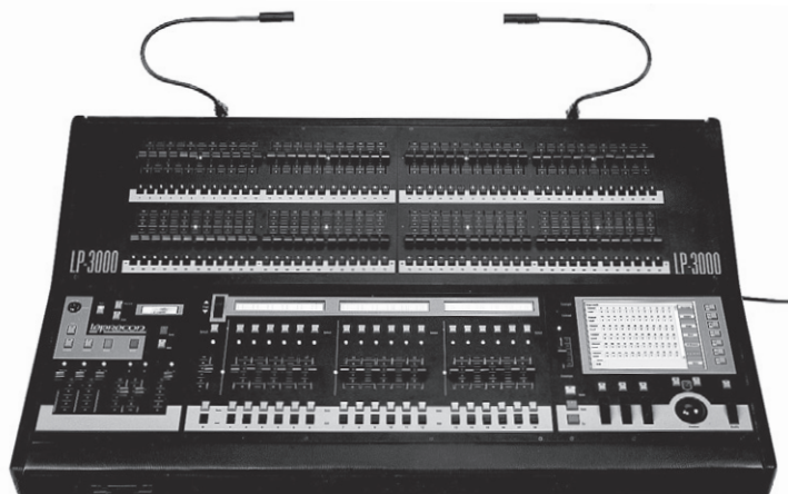
LEPRECON LP-3000 48/96 svetelný ovládací pult, 1 048 DMX kanálov, personality pre int. svetidlá, 18 submasterov, 360 programov, 500 cue, LCD, disketa, výstup monitor
