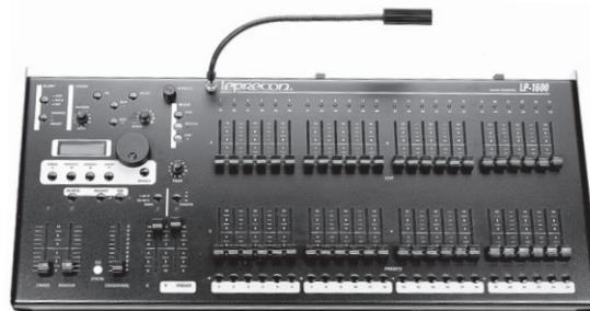
LEPRECON LP-1600 svetelný pult, 2×48 kanálov, 24×preset, 288 pamätí, 12 programov/20 krokov, výstup DMX 512, záloh. FDD 3,5", výstup VGA, externý zdroj
