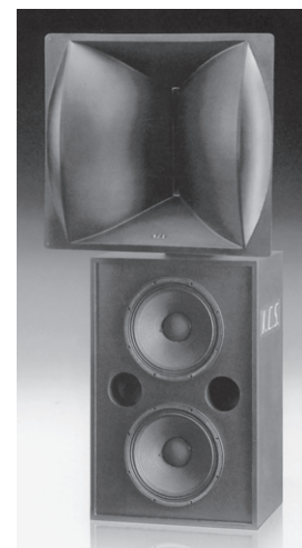
KCS S3001 IHX 2×15" + 1×2", 1 200 W/100 dB, 80 W/112 dB, biamp, hĺbka 945 mm, výška 1 815 mm
