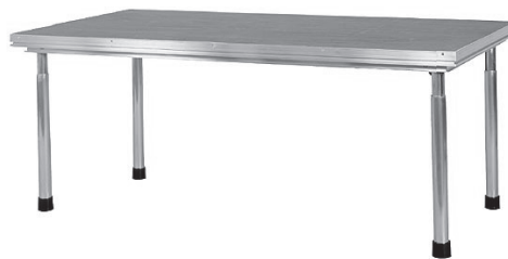
MILOS X-stage S2 pódiový modul 200×100 cm, bez stojek, ALU rám + překližka 22 mm, max. zátěž 750 kg/m 2 , hmotnost 40 kg, bez spojovacích konektorů
