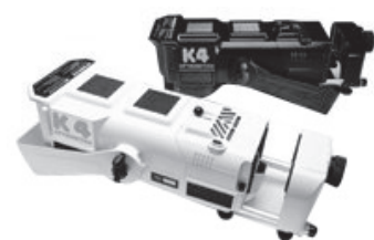
K4 lampa MSR 575-2/750 hodin, objektiv 85 mm, svítivost 4 000 lm, bar. teplota 5 600 ° K, rozměry 655×315×210 mm, hmotnost 12,3 kg
