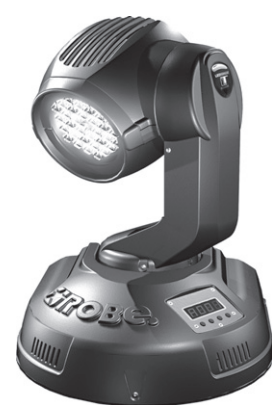
LEDWash 136LT otočná hlava, mechanicky shodná s modelem AT 170, světelný zdroj 36×1 W LED Luxeon, 12×Green, 12×RED, 12×Blue, RGB mix barev, úhel paprsku 15°, dimmer 0-100 %, strobo 1-25/sek., rozměry 418×326×362 mm, hmotnost 11 kg
