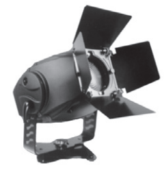
AT ColorMix 250 statický WASH, výstup 8–22°, čočka FRESNEL 150 mm, RGB mix barev, 3 200/5 600 K, dimmer, lampa CDM-SA/T 150 W, hmotnost 13,5 kg
