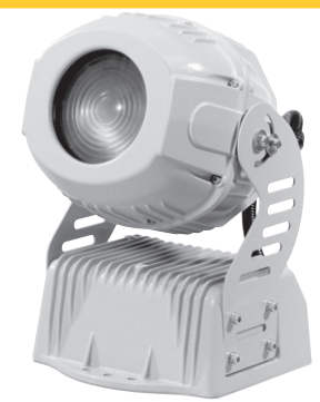
XT Ecolor 250 statický barevný měnič, WASH, DMX 512, lampa MSD 250, barvy mix CMY, kolo 6×barva, Fresnel čočka manuální 8–22°, 6 kanálů DMX, rozměry 450×295×330 mm, hmotnost 22 kg
