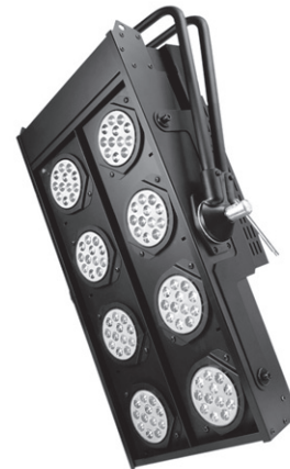
LEDBlinder 196LT blinder, 8 modulů, každý 16×1 W LED Luxeon, RGB mix barev, předprogramované barvy a rainbow efekt, strobo 1-25/sek., dimmer 0-100 %, rozměry 810×480×190 mm, hmotnost 18 kg
