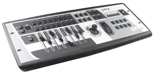
DMX Control 512 DMX ovladač inteligentních svítidel, 16 strojů po maximálně 32 kanálech, 1 024 scén, 512 presetů, 256 shows, generátor efektů, MIDI, RS 232, Joystick, scroller, 8×potenciometr, 170×133×482 mm, hmotnost 3,2 kg
