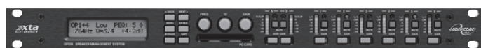
XTA DP226 DSP, 2×IN (8pásmový param. EQ) / 6×OUT (5pásmový param. EQ + HP a LP filtry, limiter, delay), >110 dB
